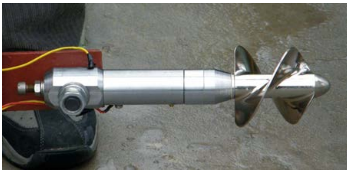
Fot.3-2b Młynek z wirnikiem o osi poziomej
