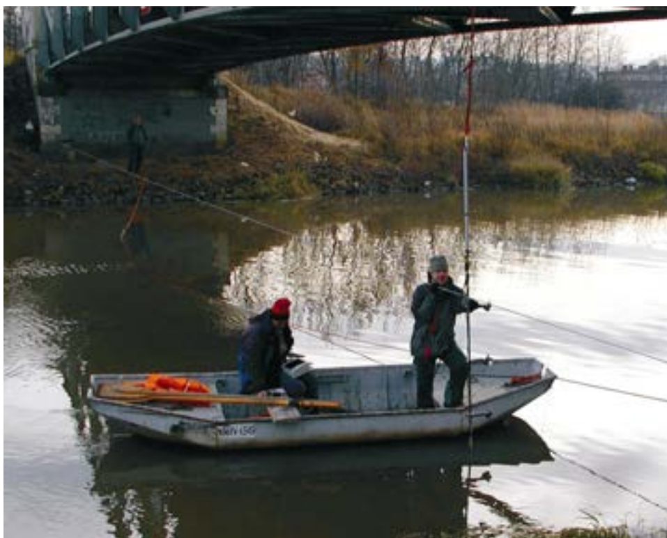
Fot.3-3 Pomiar natężenia przepływu za pomocą młynków osadzonych na tyczce (Kanał Łęczański pod Krakowem)
