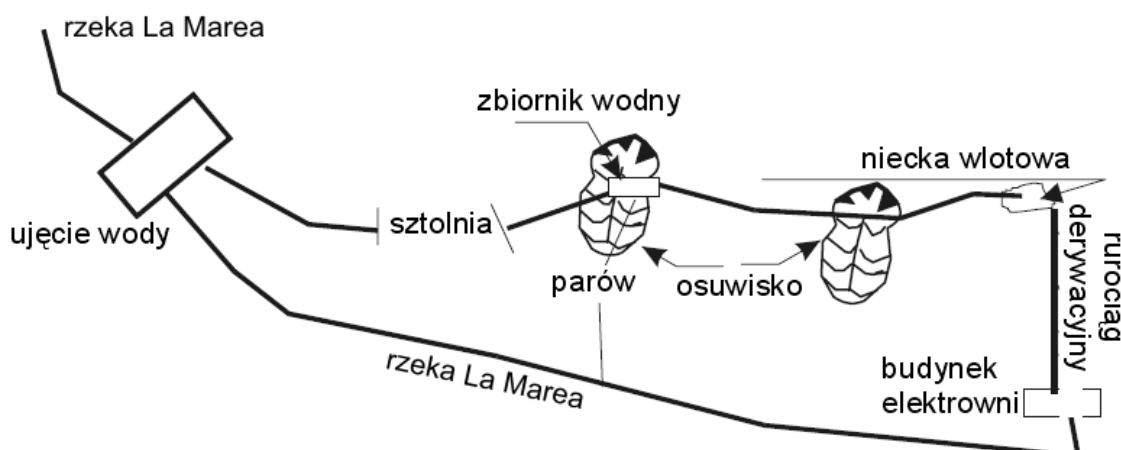
Rysunek 4-11 Schemat poziomy elektrowni La Marea
