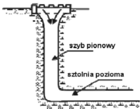
Rysunek 5-14 Schemat przelewu szybowego
